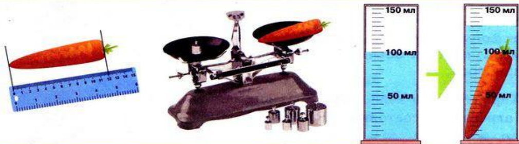
Рис. 11. Измерение размера, массы и объёма тела неправильной формы
